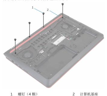
5 提起计算机基座,然后使用塑料划片,将掌垫部件其计算机基座中取出。
